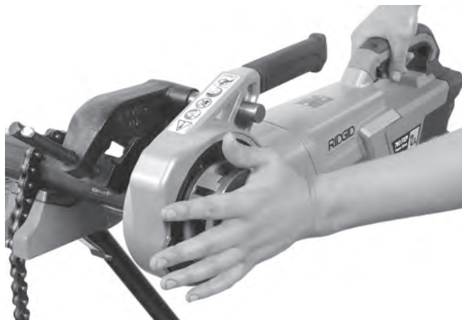
図 13A – ダイヘッドのカバープレートでねじ切りを始める
