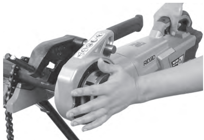
그림 13A - 다이 헤드 덮개판을 사용하여 나사산 가공 시작
