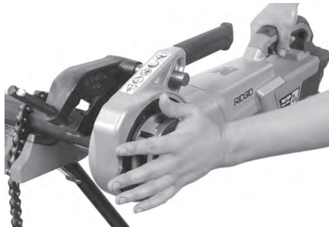
图 13A - 使用牙模头盖板开始套丝
