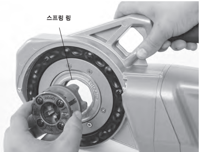
그림 8 - 1¼" 이하 11-R 다이 헤드 설치(760 FXP 11-R만 해당)
