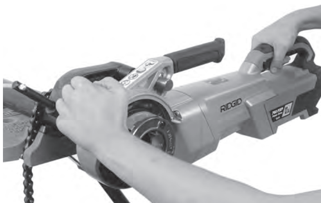
図 13B – プッシュパッドでねじ切りを始める
