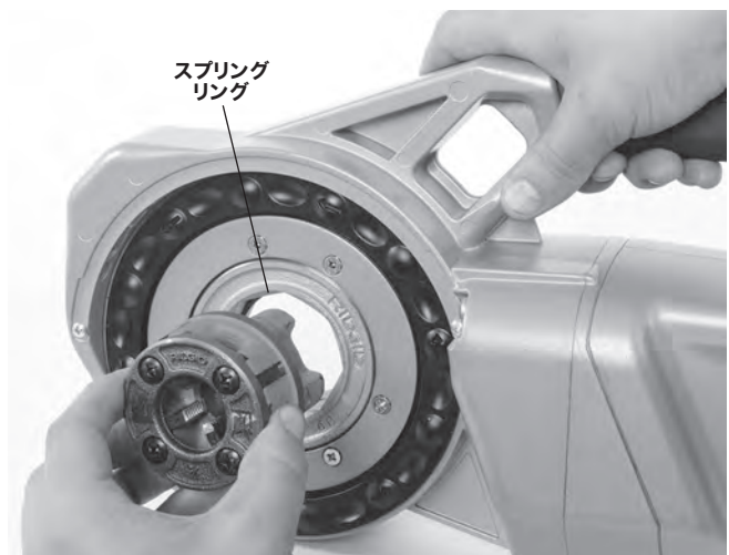
図 8 – 1¼インチ以下の 11-R ダイヘッド (760 FXP 11-R のみ) の取り付け
