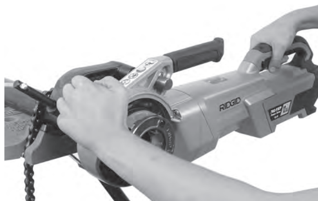
图 13B - 使用推块开始套丝
