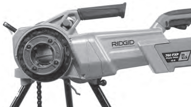
図 11 – 760 FXP パワードライブの正しい配置
