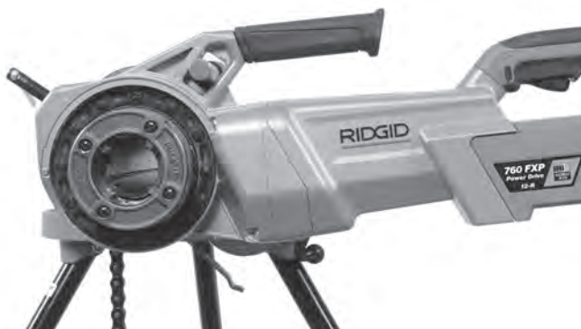
图 11 - 760 FXP 动力驱动器的正确方向
